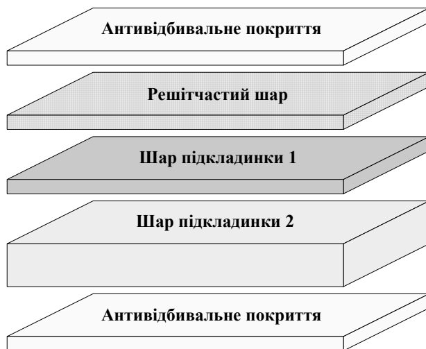
Рис. 3 – Нано-оптична мікросхема складається із множини оптичних шарів, що оточують решітчасту структуру парціальної довжини хвилі
