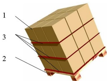
Рис. 3. Схема скріплення транспортного пакета за допомогою прокладки Non-SlipSafetyGripforPallets:
