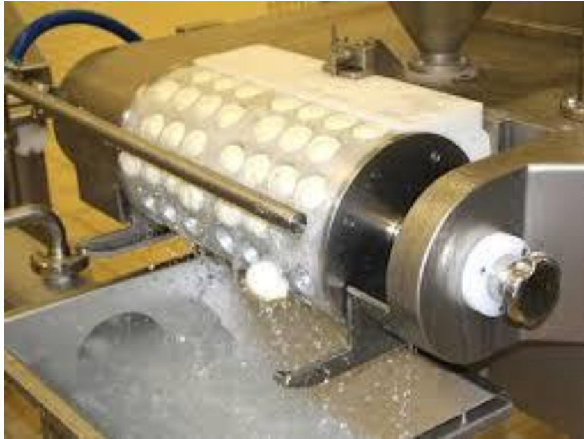
Рисунок Г.1 – Работа формовочного апарату для моцарели
