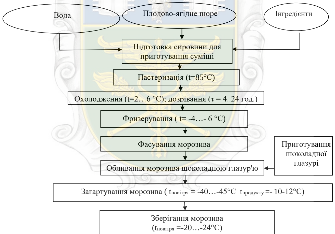
Рисунок 2.1 – Технологічна схема виробництва плодово-ягідного морозива в шоколадній глазурі
