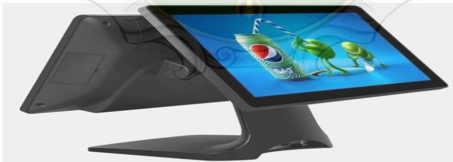
Рисунок 3.1 - POS термінал Likeros Dual з екраном покупця 15''
