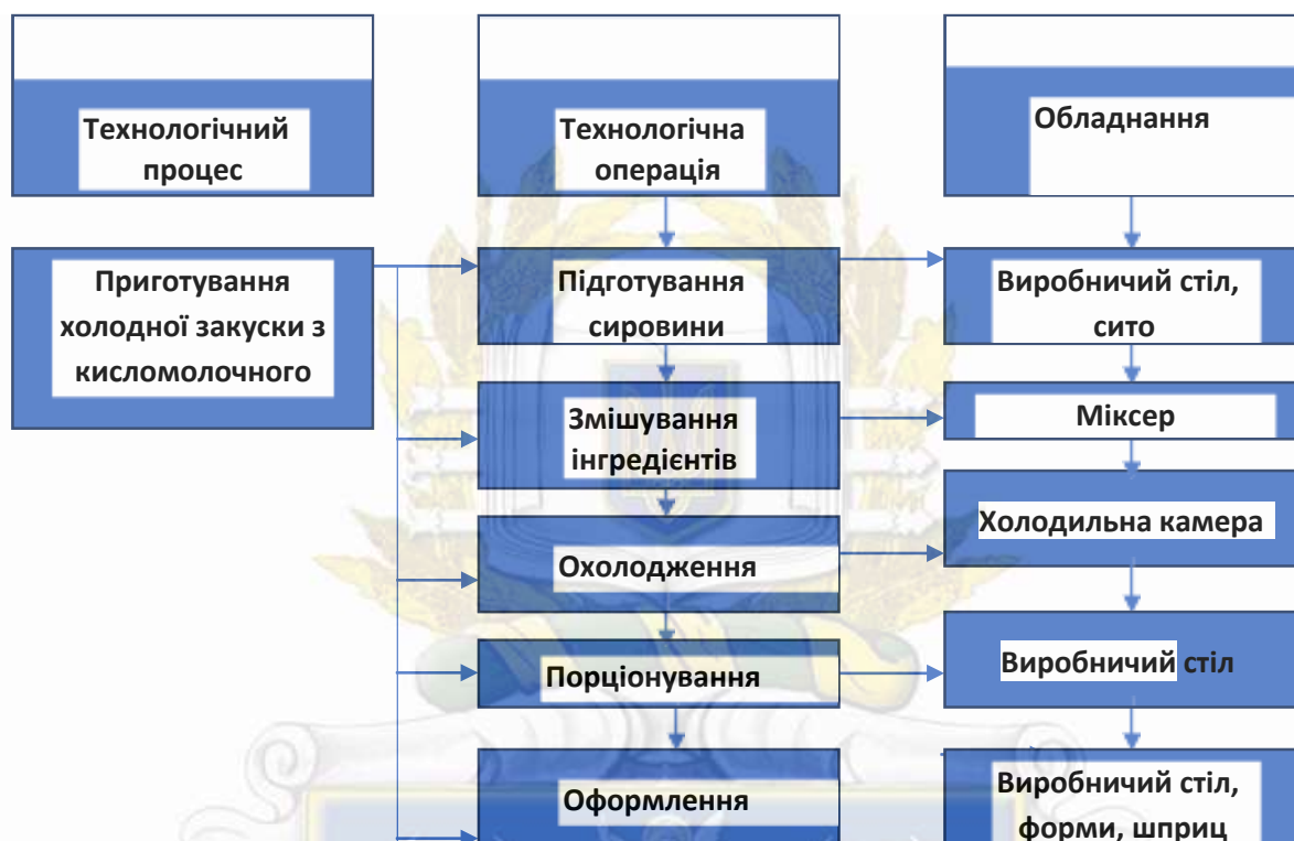
Рисунок 2.1 – Блок-схема організації виробництва холодної закуски з кисломолочного сиру в холодному цеху ЗРГ
