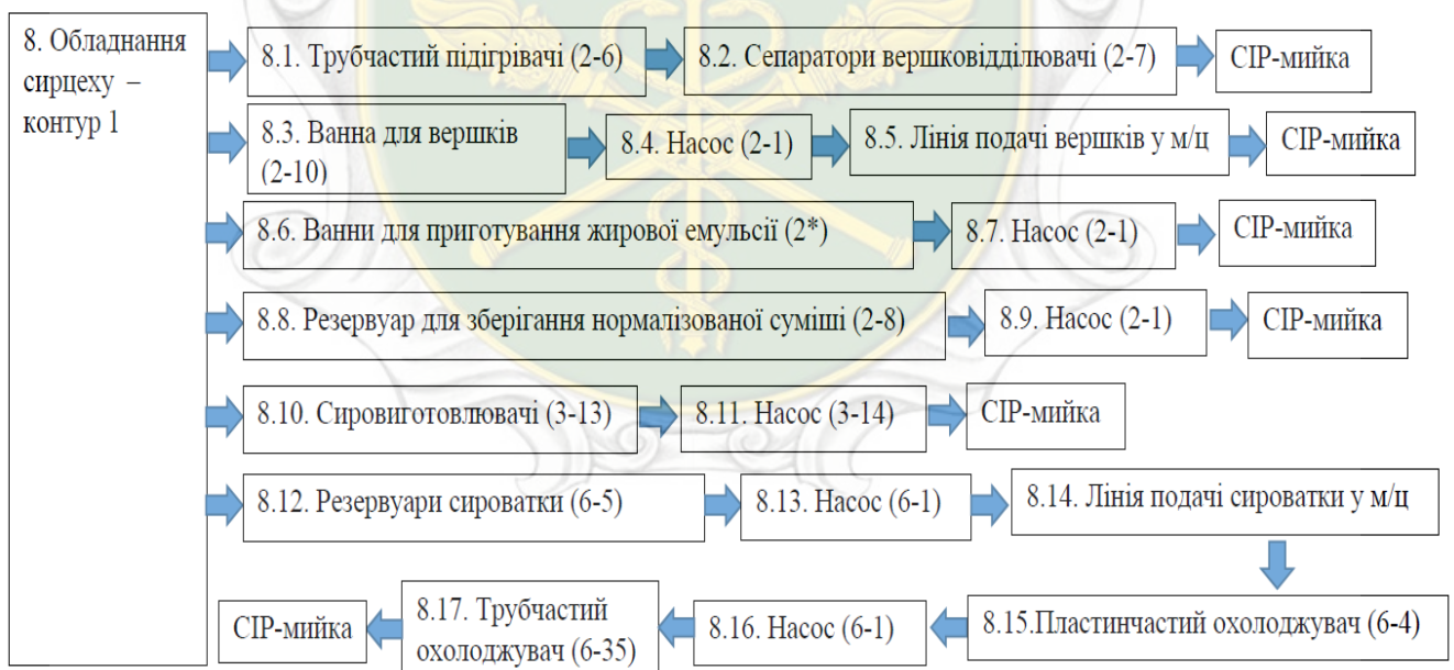
Рисунок 2.18 – Блок-схема миття обладнання сирцеху
